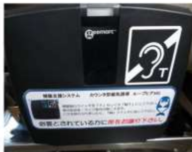
車内に設置された磁気ループ
